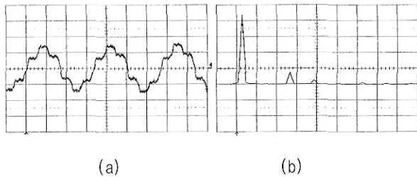
그림 11 CO 2 아크 용접시 6고조파를 주입하지 않았을 경우 M=1.29 (a) 입력전류 (20A/div., 5ms/div.)와 (b) 주파수 스펙트럼 파형 (5A/div.) Fig. 11 (a) Input current waveform (20A/div., 5ms/div.) and (b) frequency spectrum of CO 2 arc welding machine without harmonic injection (5A/div.) M=1.29
