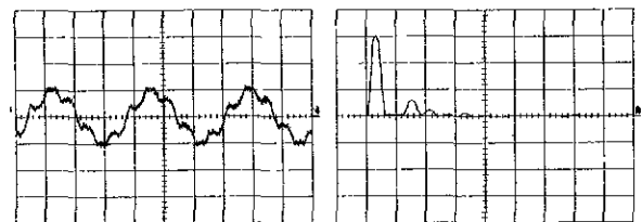
그림 5 6 고조파 비주입시의 입력전류(20A/div, 5ms/div)와 주파수 스펙트럼 파형(5A/div) M=1.29 Fig 5 Current waveform(20A/div, 5ms/div) and frequency spectrum without harmonic injection (5A/div) M=1.29
