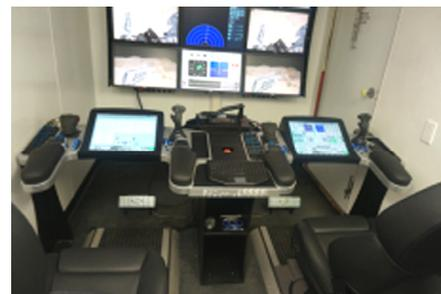
그림 2. Schilling Robotics ROV 제어 콘솔.
