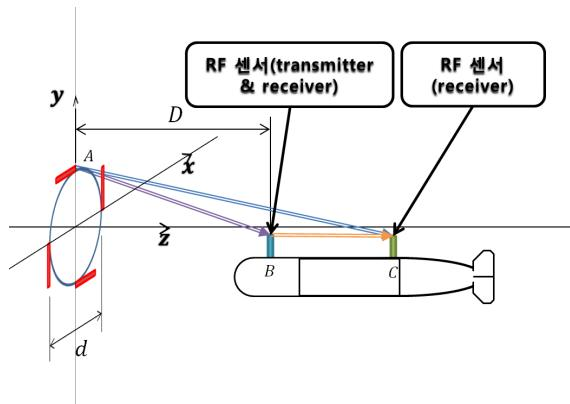
그림 12. 도킹 스테이션과 UUV에 배치된 RF sensor간 거리.
