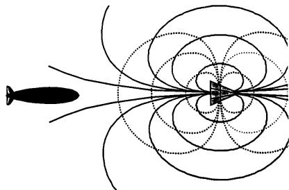
그림 5. 자기력선과 독으로 구성된 EM 유도 시스템의 개략도 [14].
