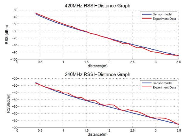
그림 6. Calibration을 포함한 센서 모델과 실험값 비교 [15].
