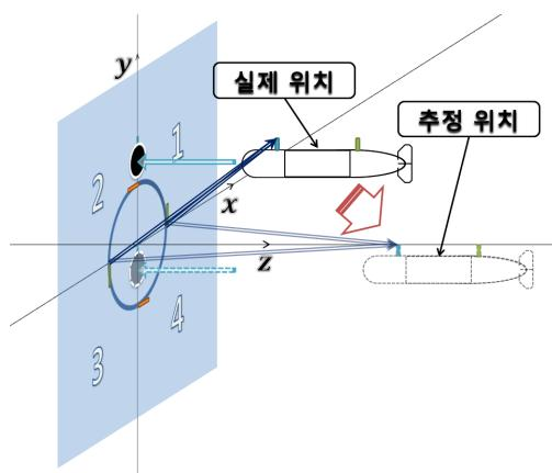
그림 11. x축에 설치된 RF sensor에서의 위치 오차.
