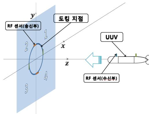
그림 10. UUV의 진행 방향 및 도킹 시스템 개략도.
