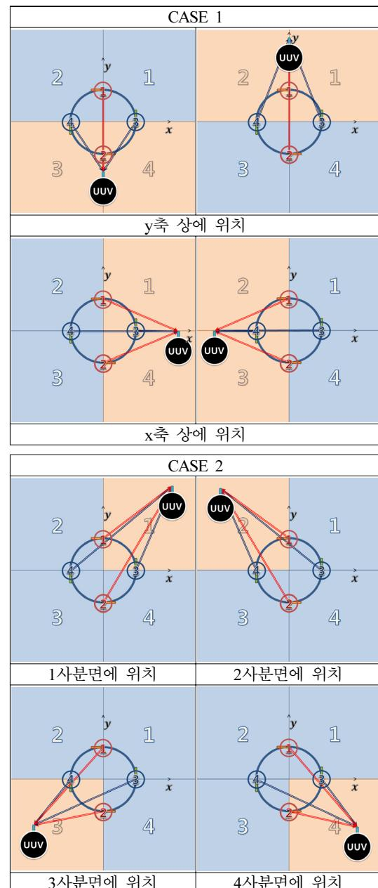
그림 14. 센서 값에 따른 UUV의 추정 위치.
